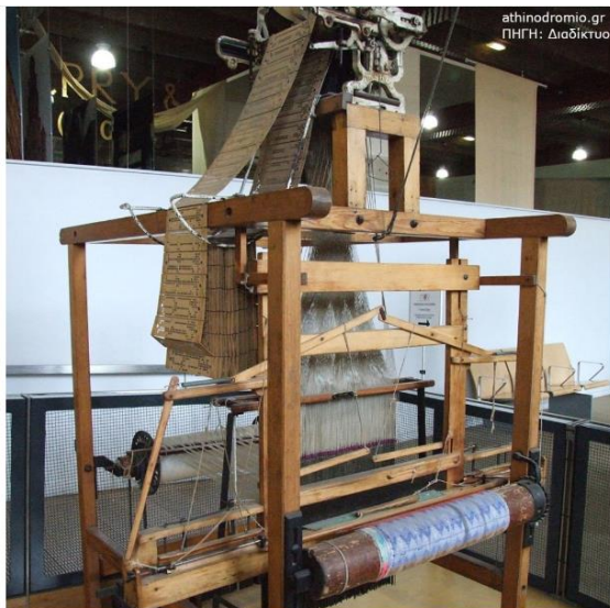
Εικόνα 1.1.6 Ο αυτόματος αργαλειός. Στην κορυφή φαίνονται οι διάτρητες κάρτες που ελέγχουν την ύφανση. Κάθε σχέδιο χρειάζεται έναν πολύ μεγάλο αριθμό διάτρητων καρτών για την απεικόνιση
