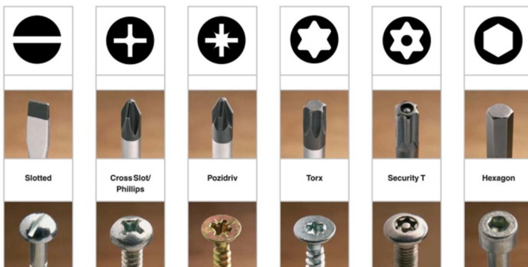
Αντιστοιχίες κατσαβιδιών με βίδες Πηγή: www.diybyexample.info
