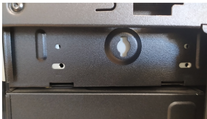
Σημεία όπου τοποθετούνται οι βίδες στήριξης της μονάδας
