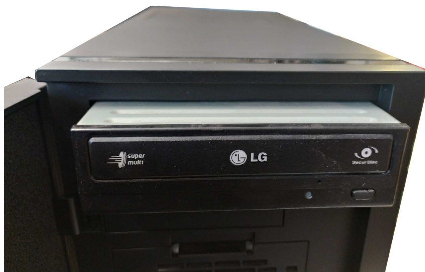
Συρταρωτή τοποθέτηση και αφαίρεση μονάδας DVD
