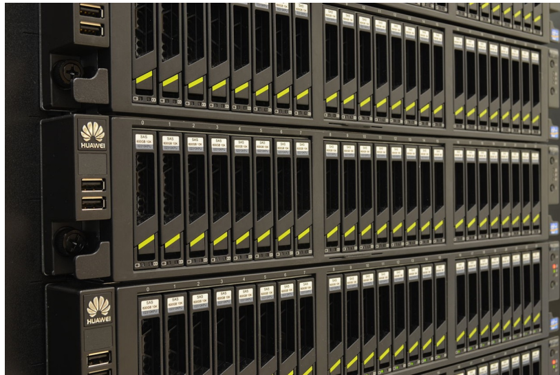
Εξυπηρετητές αρχείων. Κάθε εξυπηρετητής δέχεται έως 24 SAS δίσκους. Πηγή: https://en.wikipedia.org/wiki/Serial_Attached_SCSI#/media/File:HuaweiRH2288HV2.JPG By Open Grid Scheduler / Grid Engine - Own work, CC0, https://commons.wikimedia.org/w/index.php?curid=38267117
