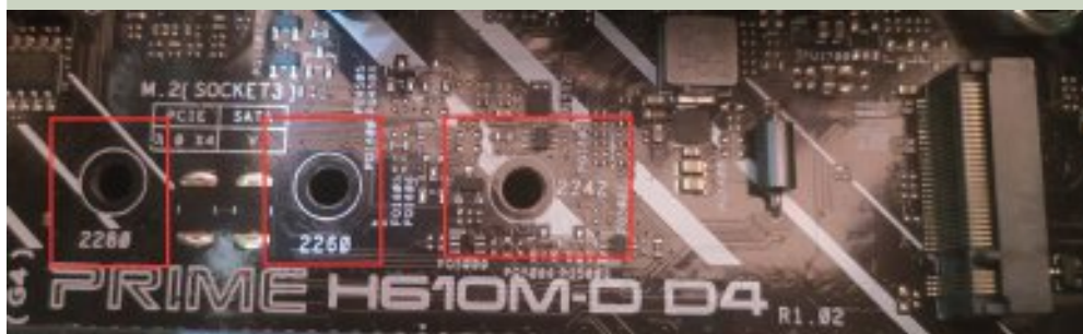
Σημείο τοποθέτησης δίσκου M.2 Παρατηρείστε τα σημεία ασφάλισης ανάλογα το μέγεθος του δίσκου
