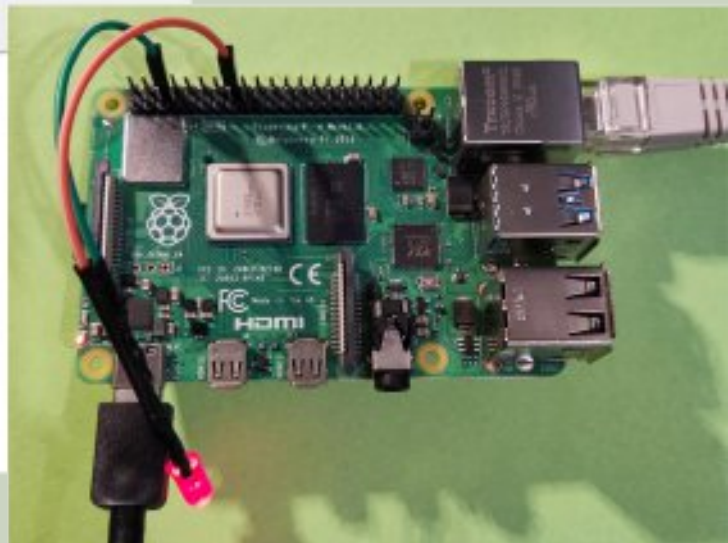
Thonny η συνάρτηση blink - Raspberry Pi 4 σύνδεση LED στην ακίδα 23
