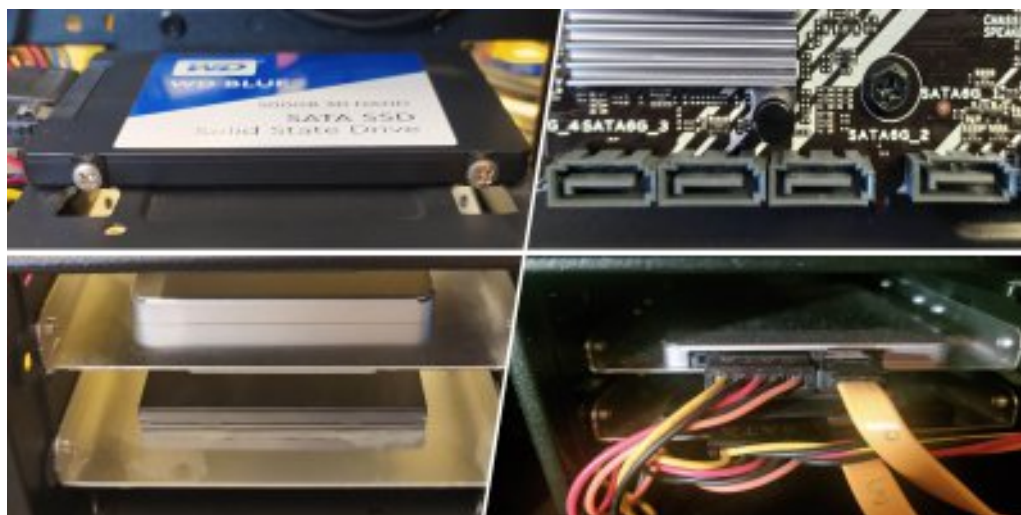
Σύνδεση SATA δίσκων SSD. Ο πρώτος δίσκος τοποθετήθηκε σε θέση 2,5" ενώ οι δύο πιο κάτω σε θέση 3,5" με χρήση βάσης.
