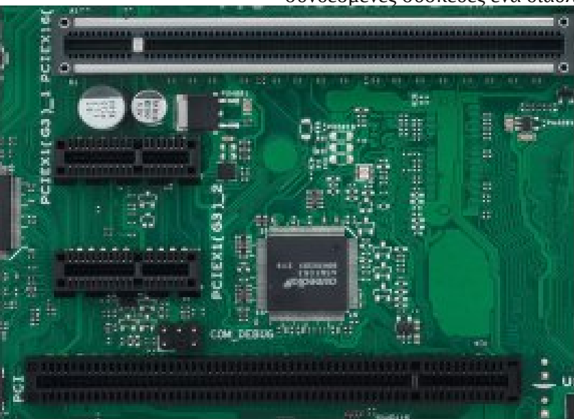
PCI και PCIe σε μητρική πλακέτα Πηγή: https://www.asus.com/motherboards-components/motherboards/csm/pro-h610m-c-csm/
