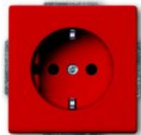
Πρίζα κόκκινου χρώματος για χρήση με σταθεροποιητή τάσης ή UPS. Το χρώμα υποδεικνύει ότι η συγκεκριμένη πρίζα είναι προστατευμένη από διακοπή ρεύματος και υπερτάσεις.
