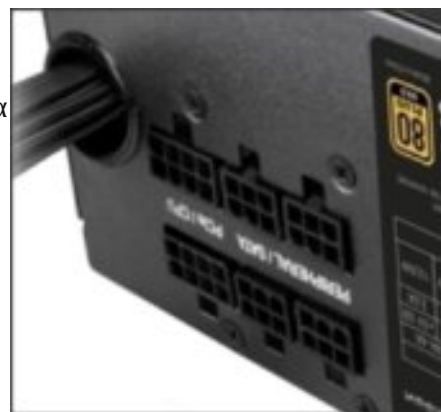
Τροφοδοτικό H/Y (Semi modular)
