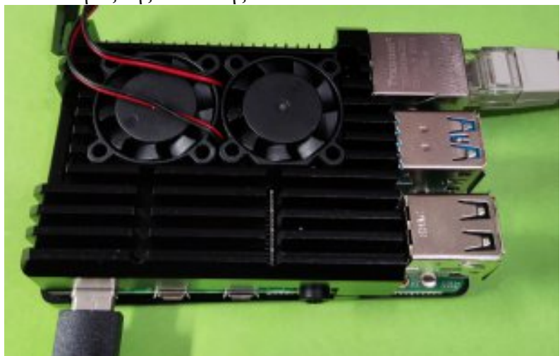
Raspberry Pi 4 Model B με επιπλέον σύστημα παθητικής ή και ενεργής ψύξης
