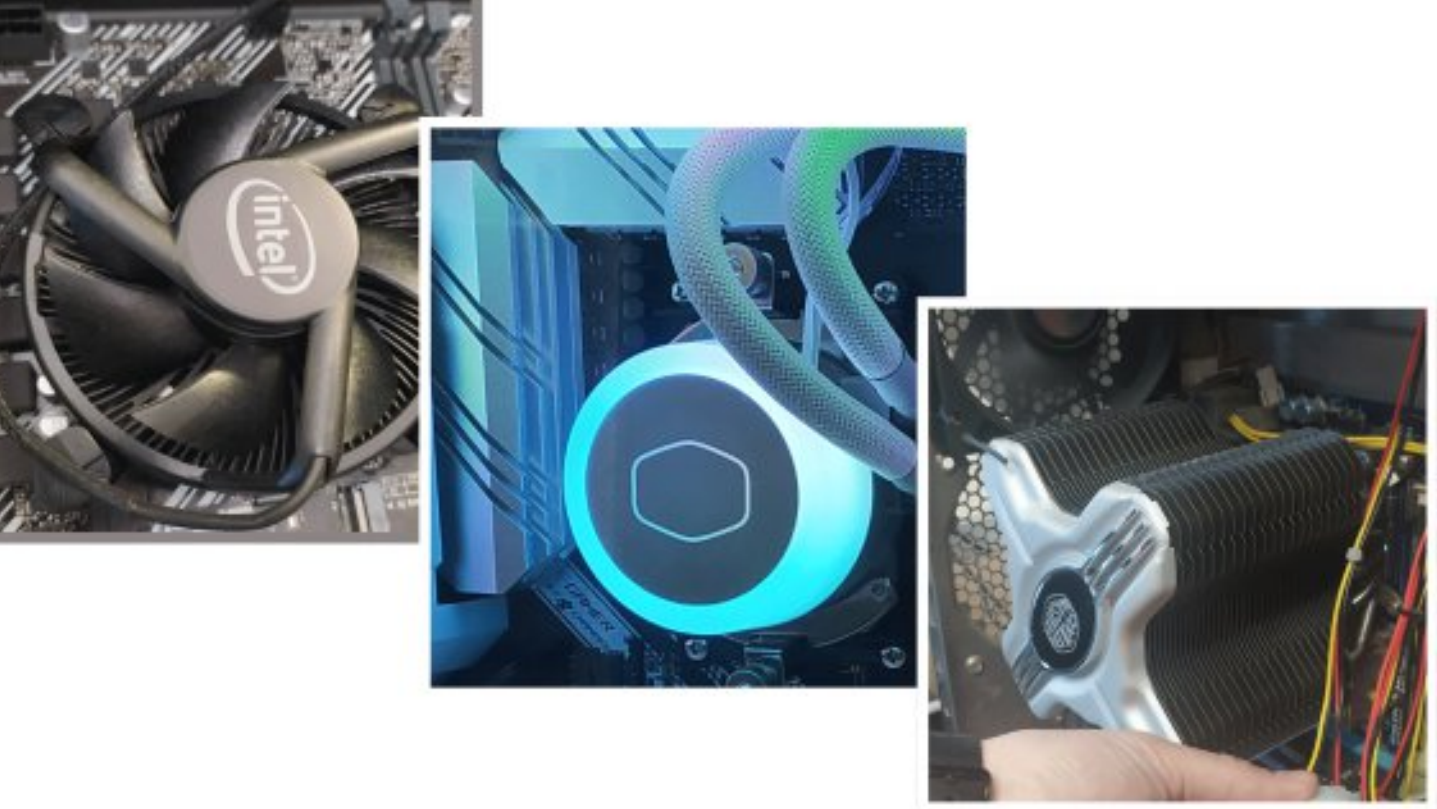
Τρία διαφορετικά είδη ψύκτρας. Με ανεμιστήρα, υδρόψυξη και χωρίς ανεμιστήρα. Προσέξτε στην τελευταία περίπτωση το μεγάλο μέγεθος της ψύκτρας.
