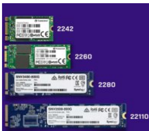
Δίσκοι M.2 ανά κατηγορία μεγέθους. Πηγή: By Sayeen - Own work, CC BY-SA 4.0, https://commons.wikimedia.org/w/index.php?curid=130292724
