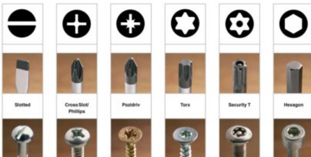
Αντιστοιχίες κατσαβιδιών με βίδες Πηγή: www.diybyexample.info
