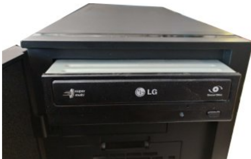
Συρταρωτή τοποθέτηση και αφαίρεση μονάδας DVD
