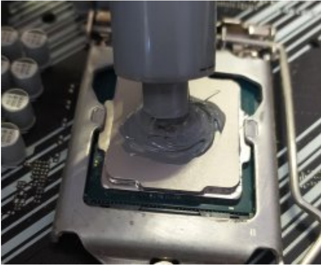
Τοποθέτηση θερμοαγωγίμης πάστας
