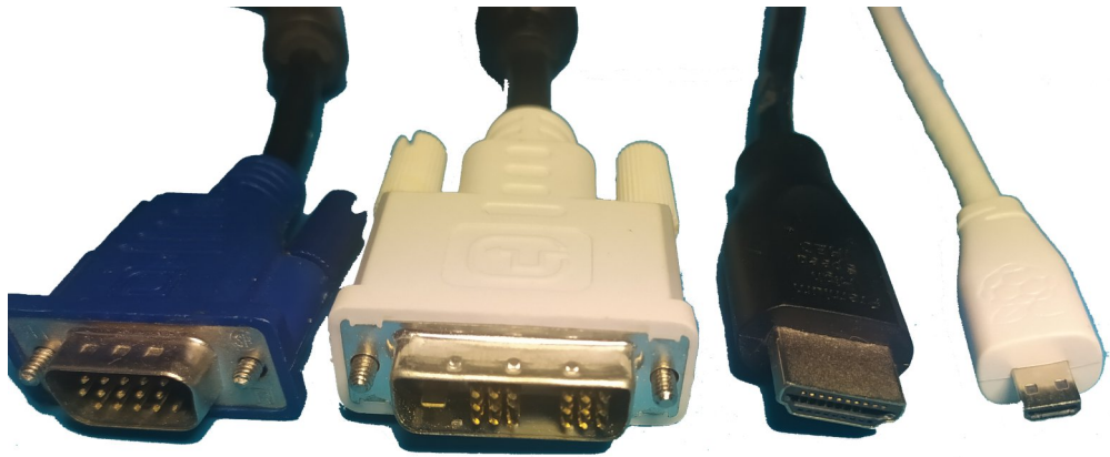
Καλώδια σύνδεσης κάρτας γραφικών με οθόνη VGA, DVI, HDMI, miniHDMI
