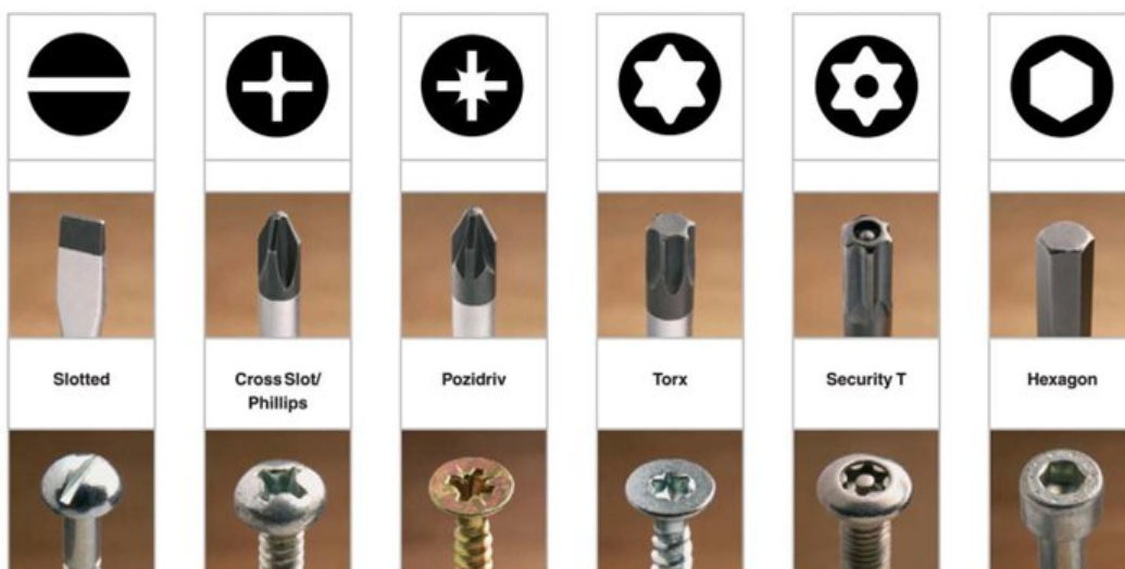
Αντιστοιχίες κατσαβιδιών με βίδες Πηγή: www.diybyexample.info
