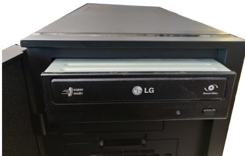
Συρταρωτή τοποθέτηση και αφαίρεση μονάδας DVD
