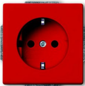
Πρίζα κόκκινου χρώματος για χρήση με σταθεροποιητή τάσης ή UPS. Το χρώμα υποδεικνύει ότι η συγκεκριμένη πρίζα είναι προστατευμένη από διακοπή ρεύματος και υπερτάσεις.
